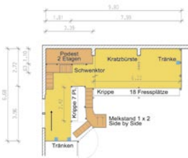
Abb. 3: Betrieb 3: In die Ecke montiertes, zweistöckiges Regal (a) und Skizze des Stallgrundrisses (b). Der Pfeil zeigt den Blickwinkel des Fotos.
