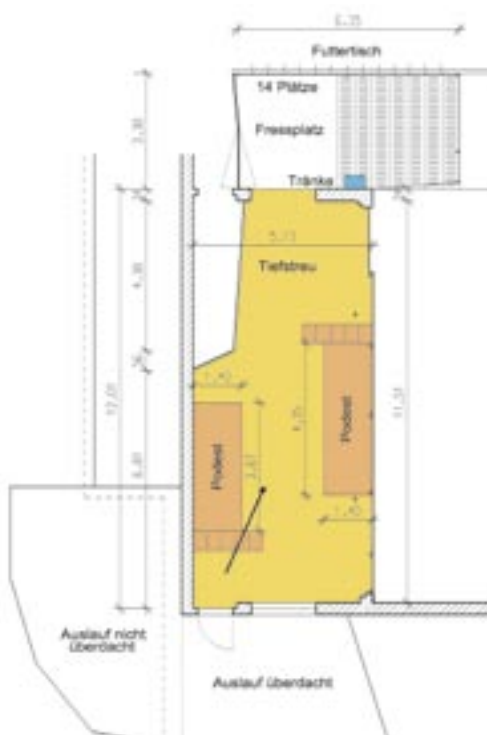
Abb. 1: Betrieb 1: Erhöhte Ebene mit schrägem Brett als Aufstieg (a) und Skizze des Stallgrundrisses (b). Der Pfeil zeigt den Blickwinkel des Fotos.
